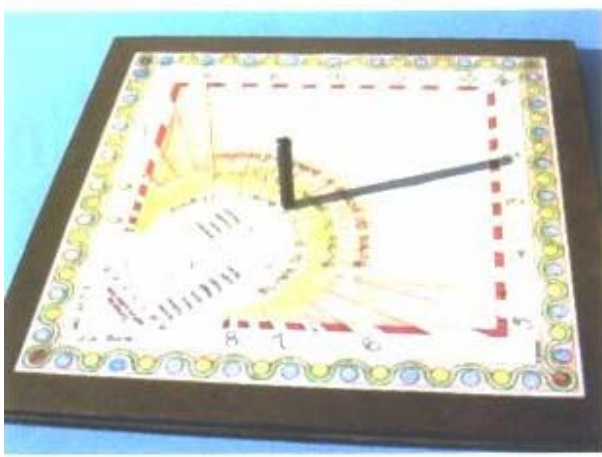
Orologio solare: tavoletta di compensato con quadrante e lo gnomone.
